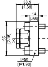
Hubabhängiger Dämpfungsdeckel Typ "D"
