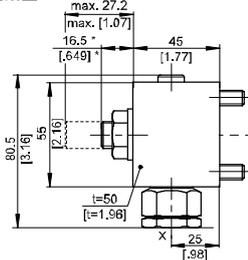
Hydraulischer Druckminderventildeckel Typ "R"
